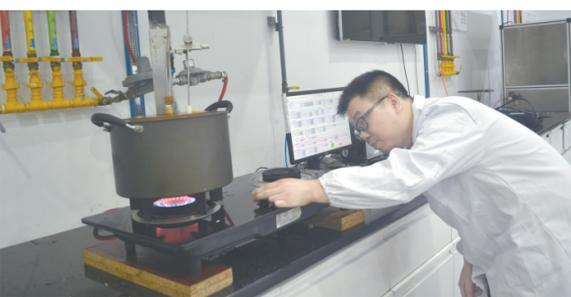
在乐宜嘉检测中心,技术人员在对乐宜嘉旗下的燃气灶ODM产品进行综合热能检测。
