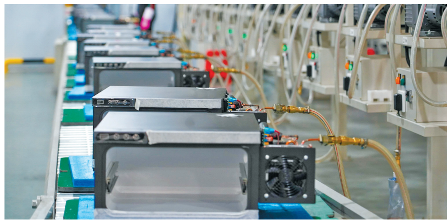
英得尔智能生产线上的车载冰箱准备灌冷媒。
