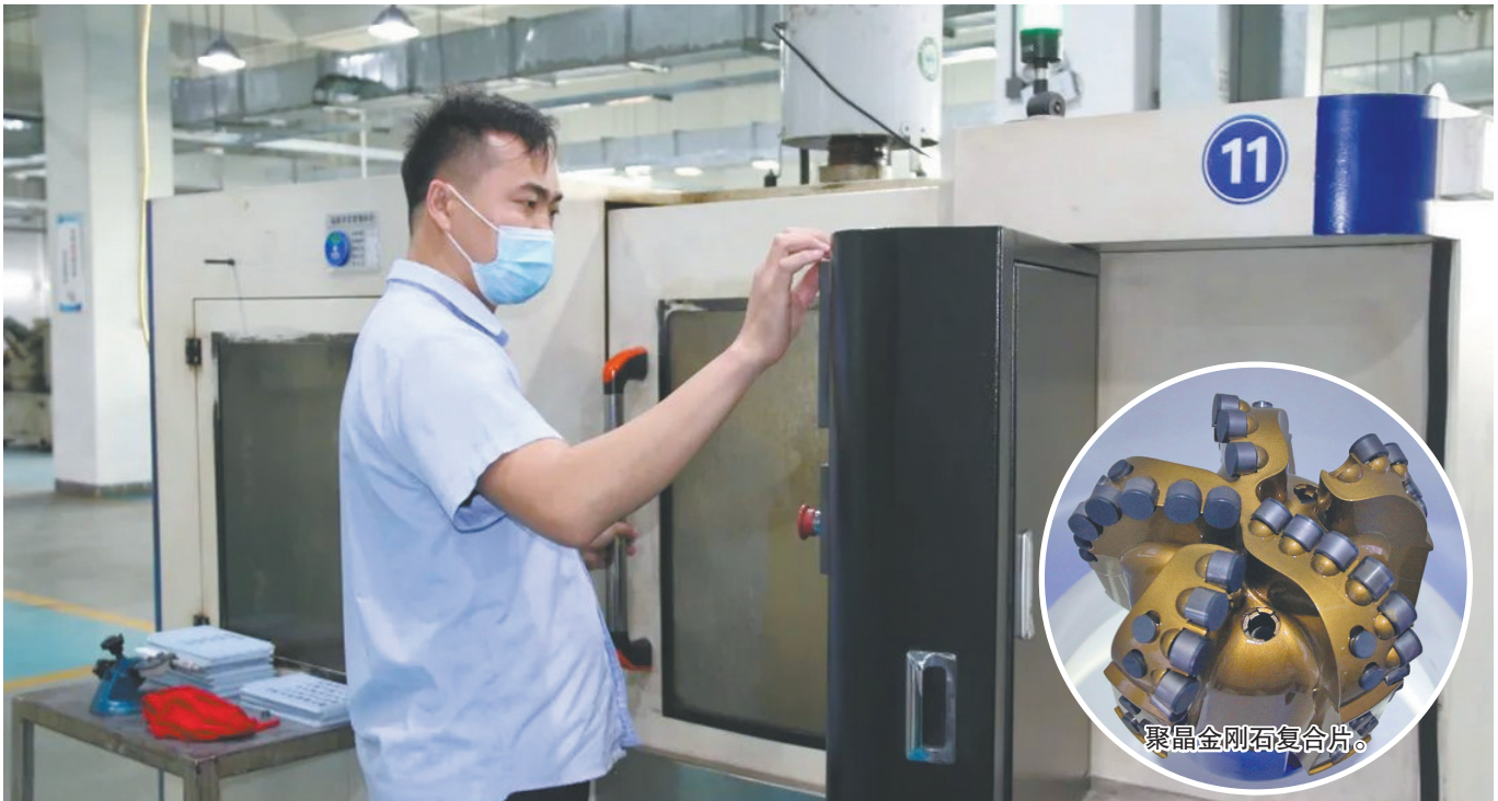
企业技术人员操控仪器对聚晶金刚石复合片外形进行加工。
