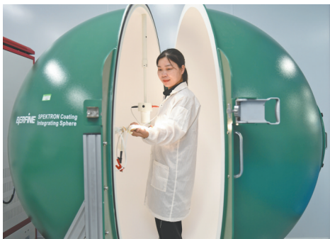
技术人员在积分球中安装测试灯带。
