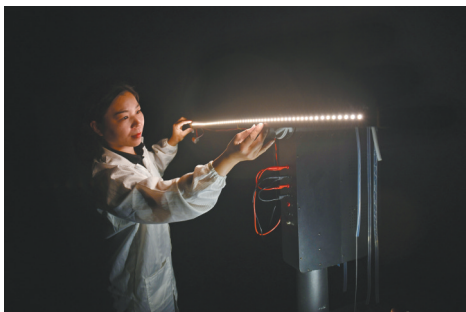
分布光度暗室中,技术人员安装测试灯带,测试产品不同角度和不同距离的空间光效。
