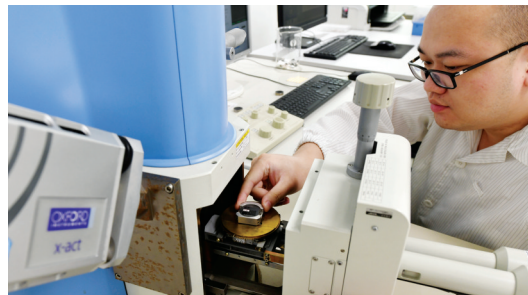
SEM-EDS用来对材料微区成分元素种类与含量进行分析,观察微小颗粒和半导体芯片平面结构。
