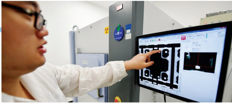
工程师正在对灯珠进行无损检测,微焦X射线检查装置用来检测成品灯珠或模组焊锡、焊线不良,也可用于器件的失效分析。
