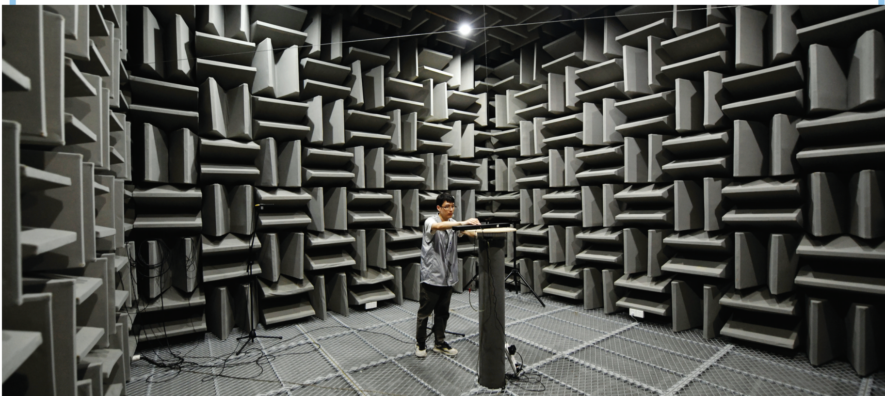
声学工程师在消音室进行产品声学曲线及特性测量。
