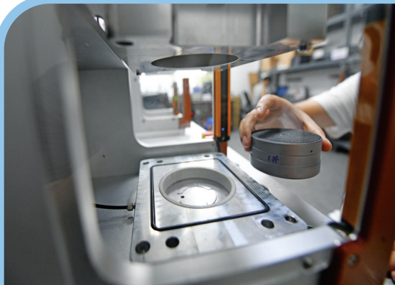
工程师正在可靠性实验室进行产品气密性检测。
