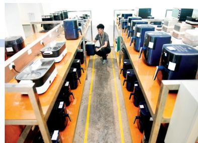
在可靠性实验室,电饭煲在额定电压条件下,以老化模式工作,试验500小时,检验其寿命。
