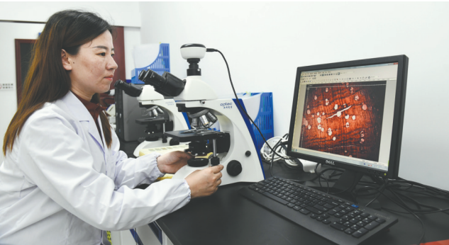
检测员通过显微镜和电脑屏幕观测红木内部结构和成分。
