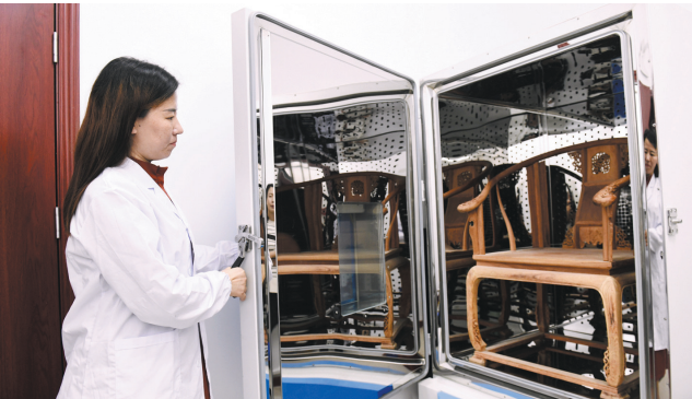
检测员将红木家具成品放进甲醛检测设备里检测。
