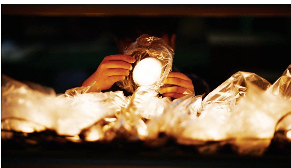
▲产品老化测试,测试产品可靠性,检测长时间工作产品的温度、亮度、色温有无异常。
