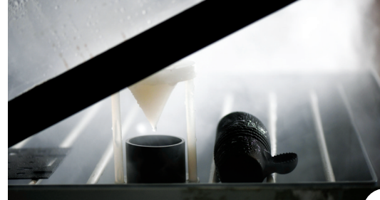
▼盐雾测试,测试产品的抗腐蚀性。
