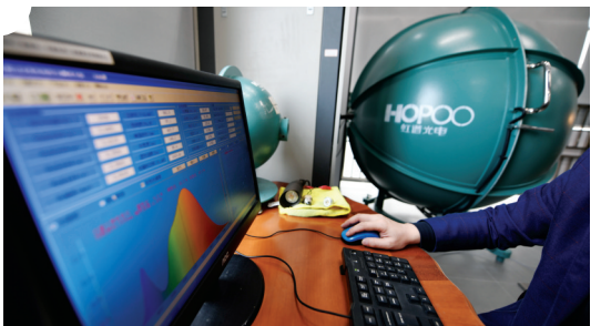
▲测试灯具的光参数:亮度,色温,显色性等。
