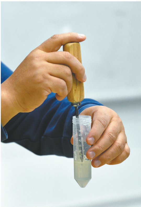
▲流体材料轻触时为液体状,大力冲击时会形成固体,阻拦和分散冲击力。
