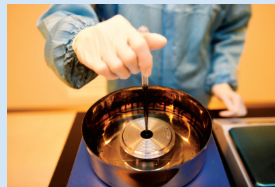
▲研发人员正在使用光刻胶进行旋转法工艺制板。
