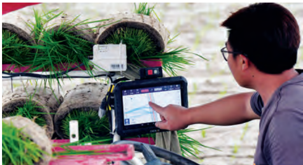
4月8日下午,陈锦坤在插秧机上开启GPS辅助插秧功能,确保插下的秧苗行列更整齐。
