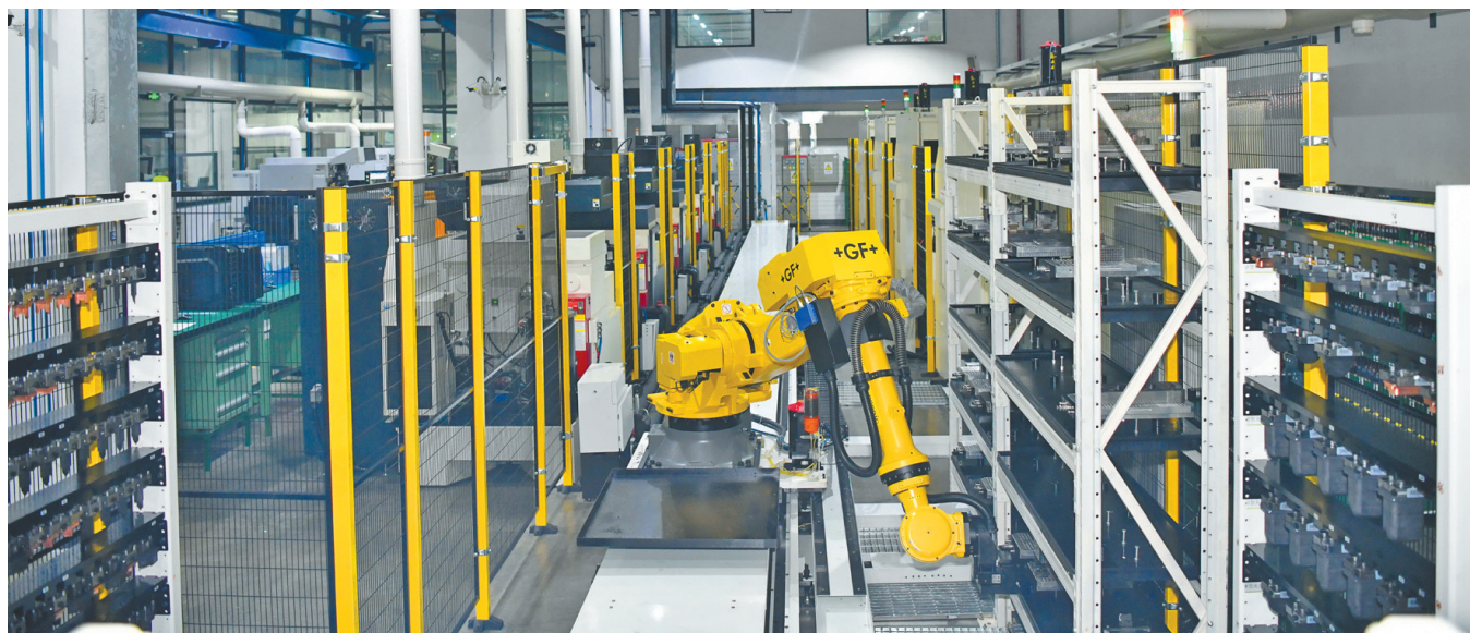
中山一家知名企业模具制造中心的柔性数机器人在钢件料库自动抓取待加工工件,以备上机加工。
