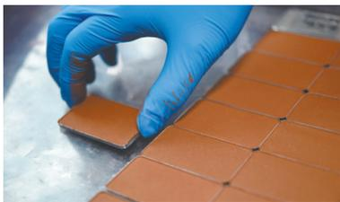
▲ 压粉完成后,打样员将半成品粉块整理排布于粉盘后送检验中心完成相关检测。
