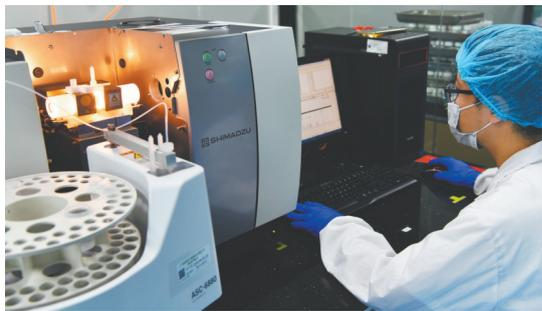
▶ 检验员正在对高效液相色谱仪进行开始检测前的调试。经过高效液相色谱仪的分析,得出化妆品中防腐剂、防晒剂的含量,确保生产过程中化妆品的防腐剂、防晒剂添加量符合配方设计要求。
