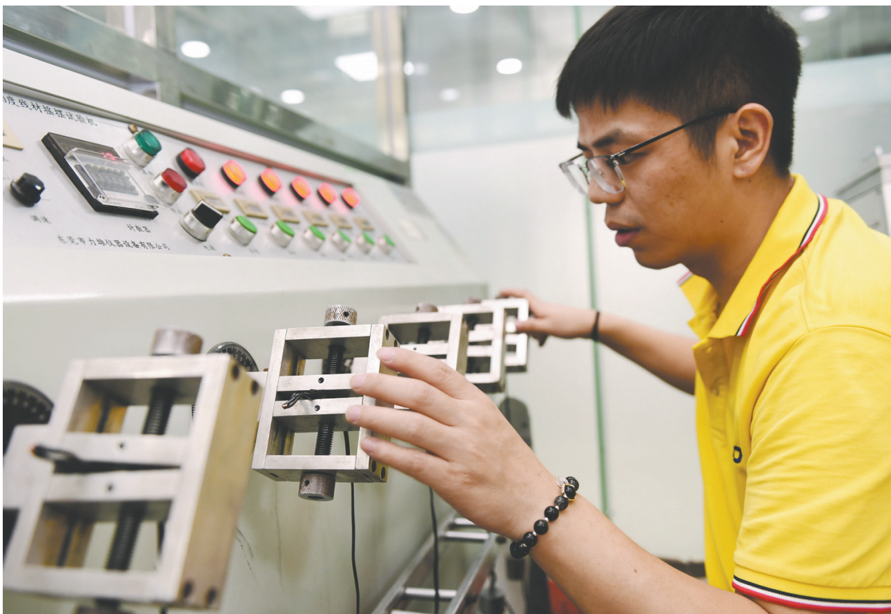
▲检测人员监测摇摆寿命试验机测试电源线的过程。
