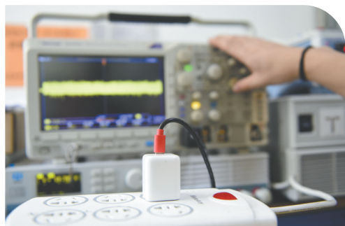
▲检测人员在进行纹波测试,查看结果是否满足规格要求。
