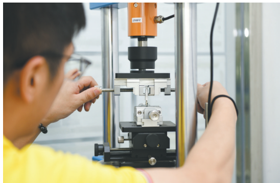
▲检验人员正在对全自动插拔力试验机进行检测前的调试。
