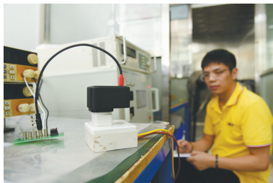
▲检验人员正在记录产品的雷击仪测试结果,对比测试数据是否满足样品开发需求。
