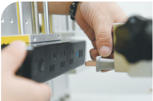
▲检验人员正在对插拔寿命试验机进行检测前的调试。
