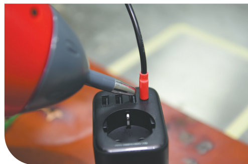
▲静电放电测试仪测试,为样品开发提供数据支撑。
