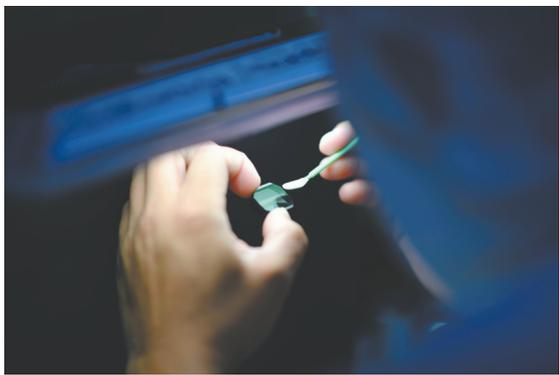
▲ 镜片表面要在专业的千级无尘室内使用工厂秘制清洁剂进行清洁,确保装入镜头内的每一枚镜片无任何脏污和尘埃。
